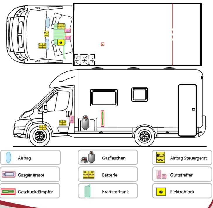
Bitte diese Rettungskarte gut sichtbar hinter der Sonnenblende auf der Fahrerseite hinterlegen!
