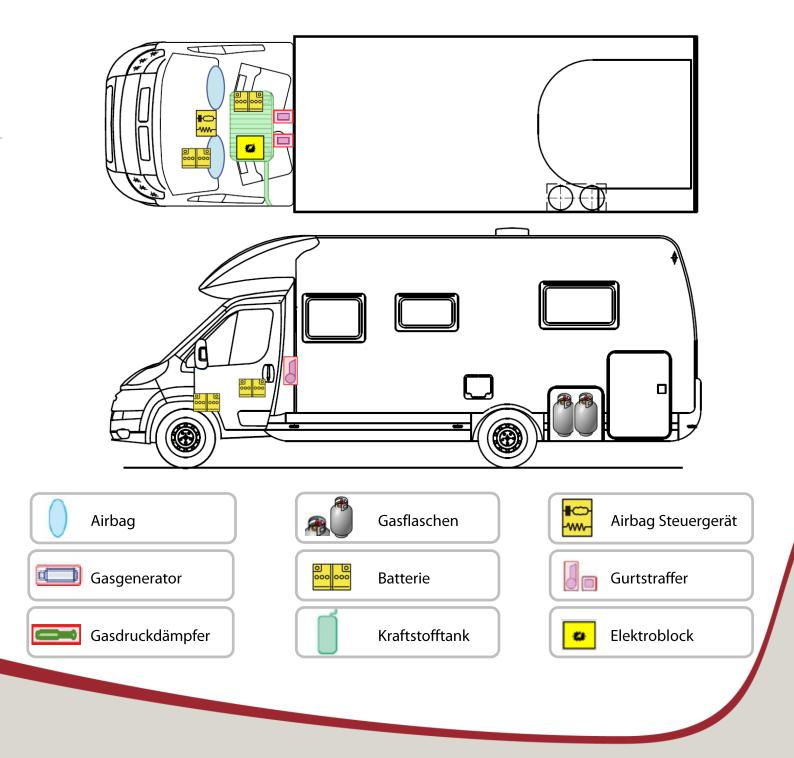
Bitte diese Rettungskarte gut sichtbar hinter der Sonnenblende auf der Fahrerseite hinterlegen!
